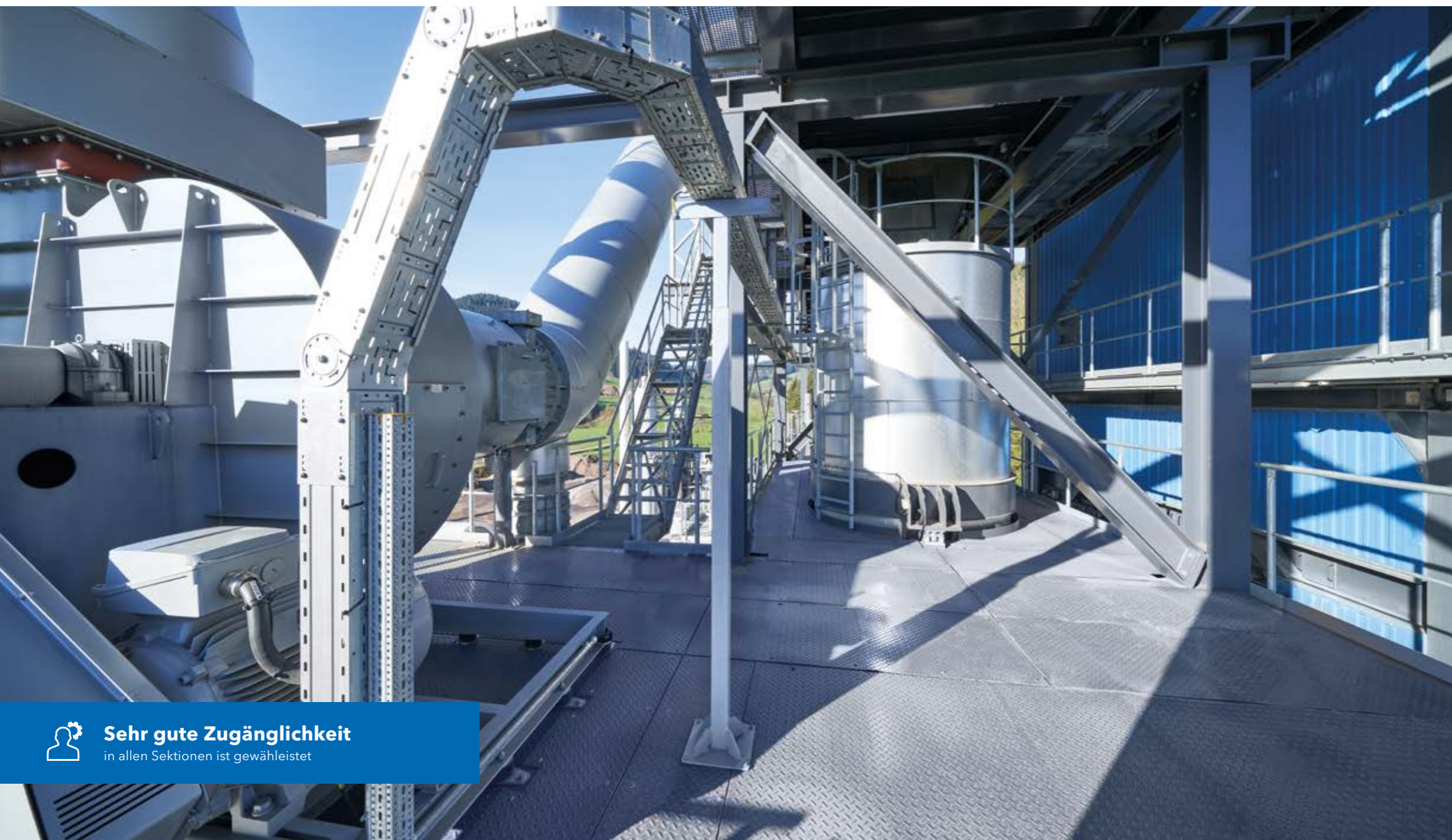
Sehr gute Zugänglichkeit in alle Bereiche durch umlaufende 800 mm Lauf- und Arbeitsbühnenbreite
