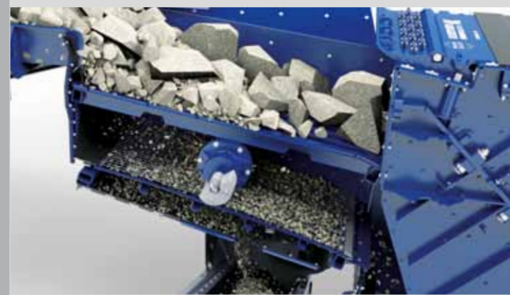
Независимый двухдечный грохот для предварительного просеивания
