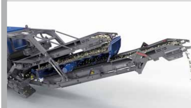
Виброгрохот с увеличенной просеивающей поверхностью
