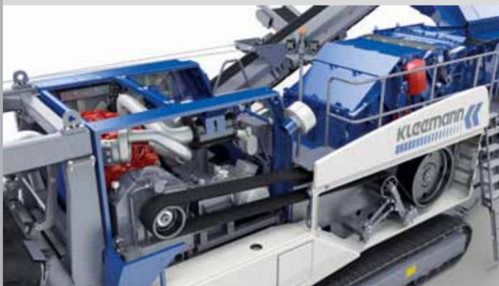
Прямой привод дробилки через гидромфуту
