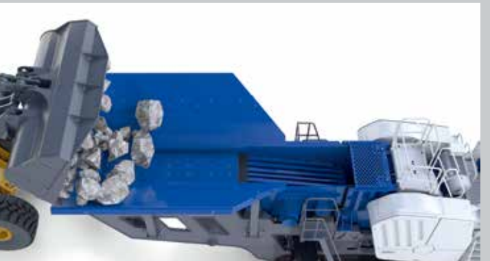
可通过轮式装载机方便地喂料, 后部的喂料宽度 = 3.8 m
