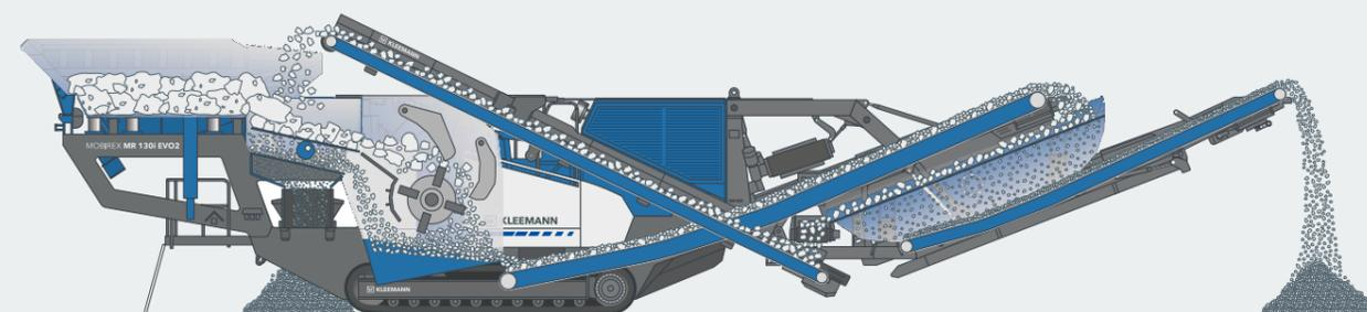
Un flux de matériaux optimal est assuré : les largeurs système du MOBIREX MR 130(i) EVO2 sont étendues sur toute l'installation dans le sens du flux de matériaux. Ainsi, le flux de matériaux n'est pas étranglé et les blocages de matériaux peuvent être efficacement évités. Grâce au réglage entièrement hydraulique de l'écartement du
