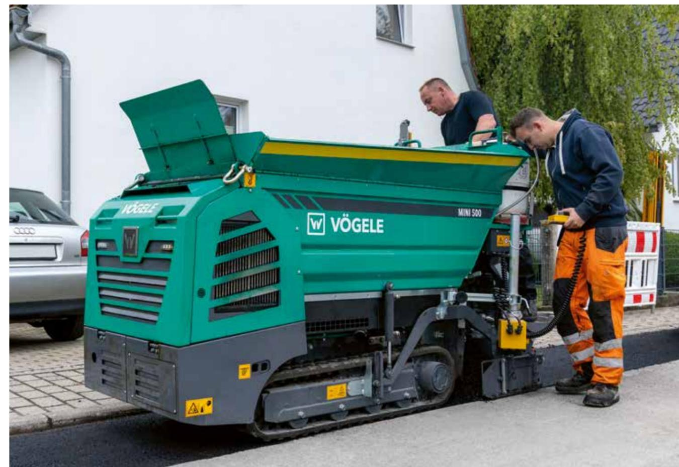
**01** Tolva de la mezcla con una capacidad de hasta 1,5 toneladas y una gran abertura en forma de embudo para una óptima carga.
