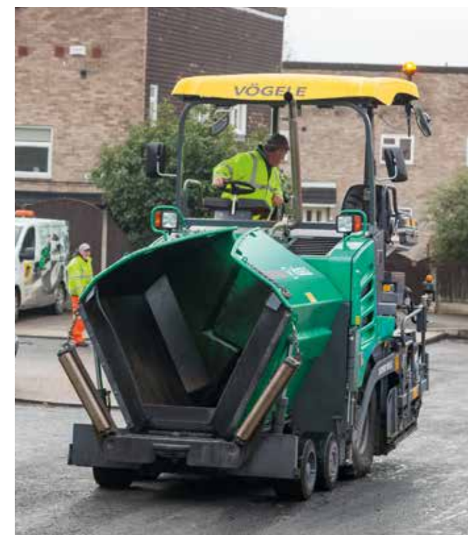
Ribaltando verso l'alto le pareti della tramoggia vengono sollevati automaticamente anche i rulli respingenti.
