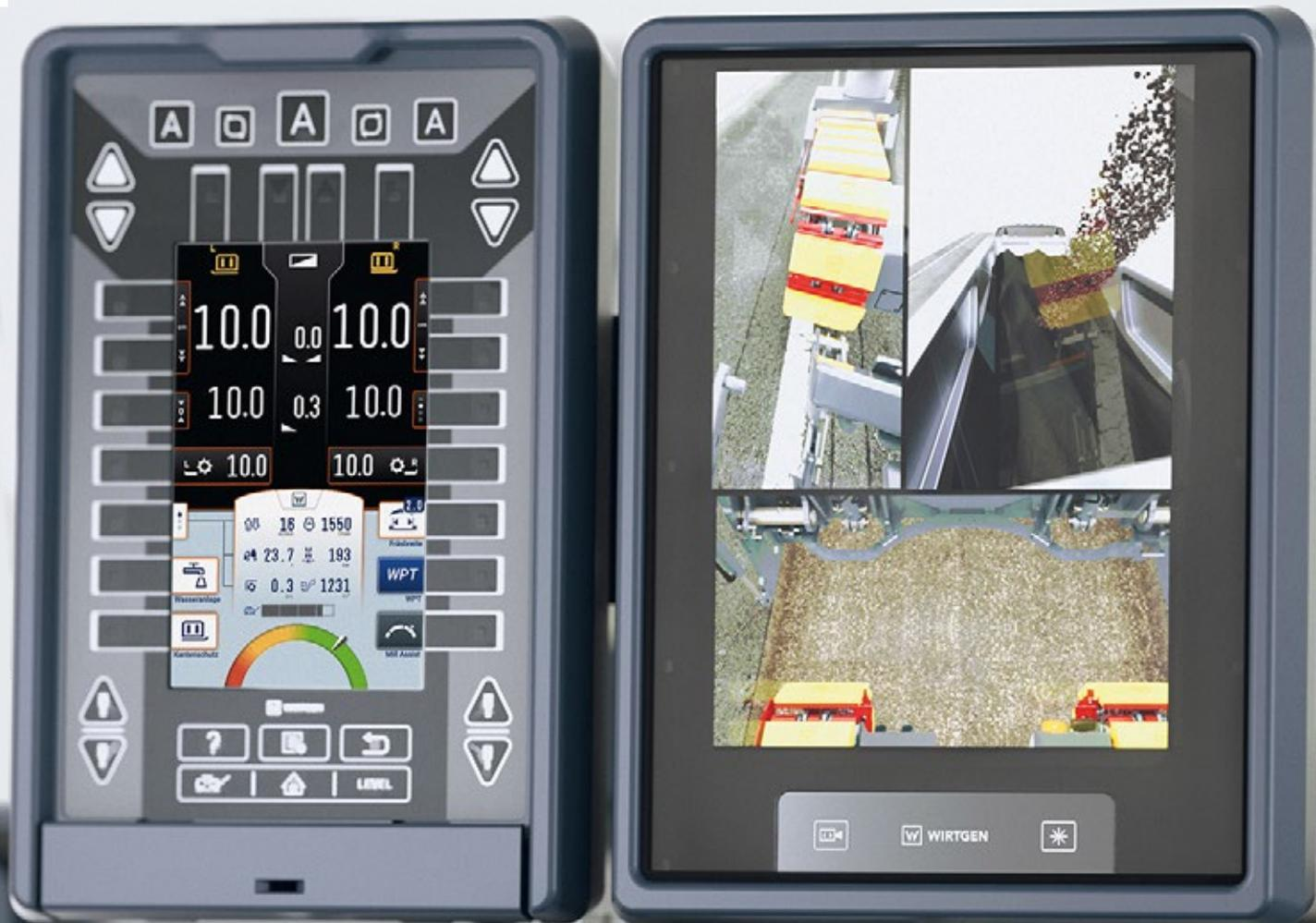
**01** Pannello di comando da 10" con schermo diviso per la visualizzazione simultanea delle immagini riprese da più telecamere.
