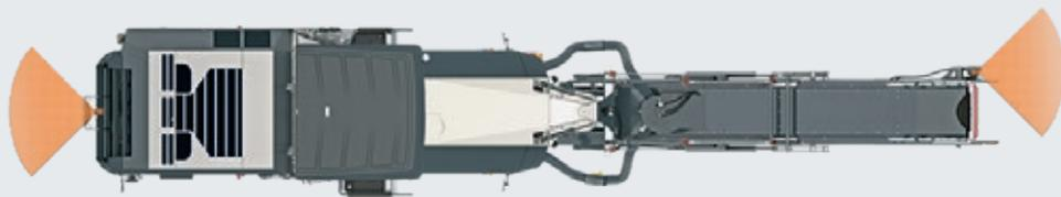
**Sistema telecamere con 2 telecamere:** telecamera posteriore / telecamera che riprende la situazione di carico
