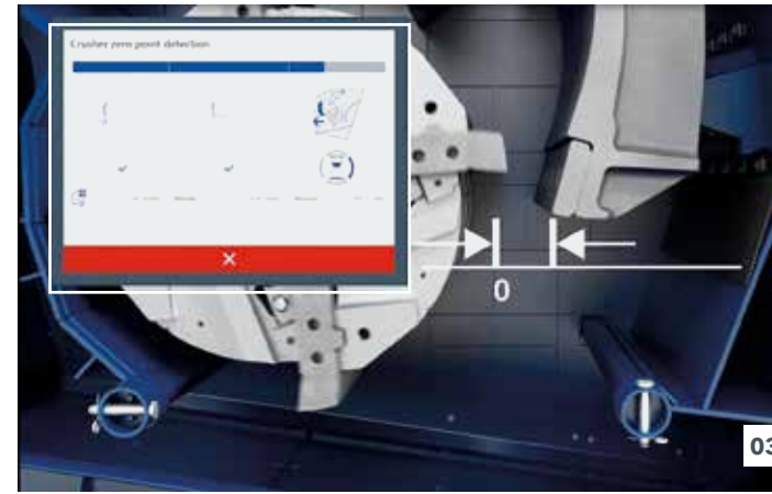
01 Kırıcı geometrisi 02 Rotor çekiçleri 03 Kırma boşluğu ayarı 04 Aşırı yük sistemi
