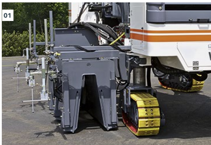
01 - 02 Molde deslizante offset com função telescópica hidráulica.
