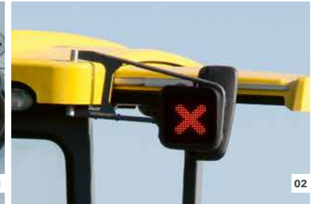
01 Taster für die Wahl der Drehzahlstufe 02 PaveDock Assistant (Option)
