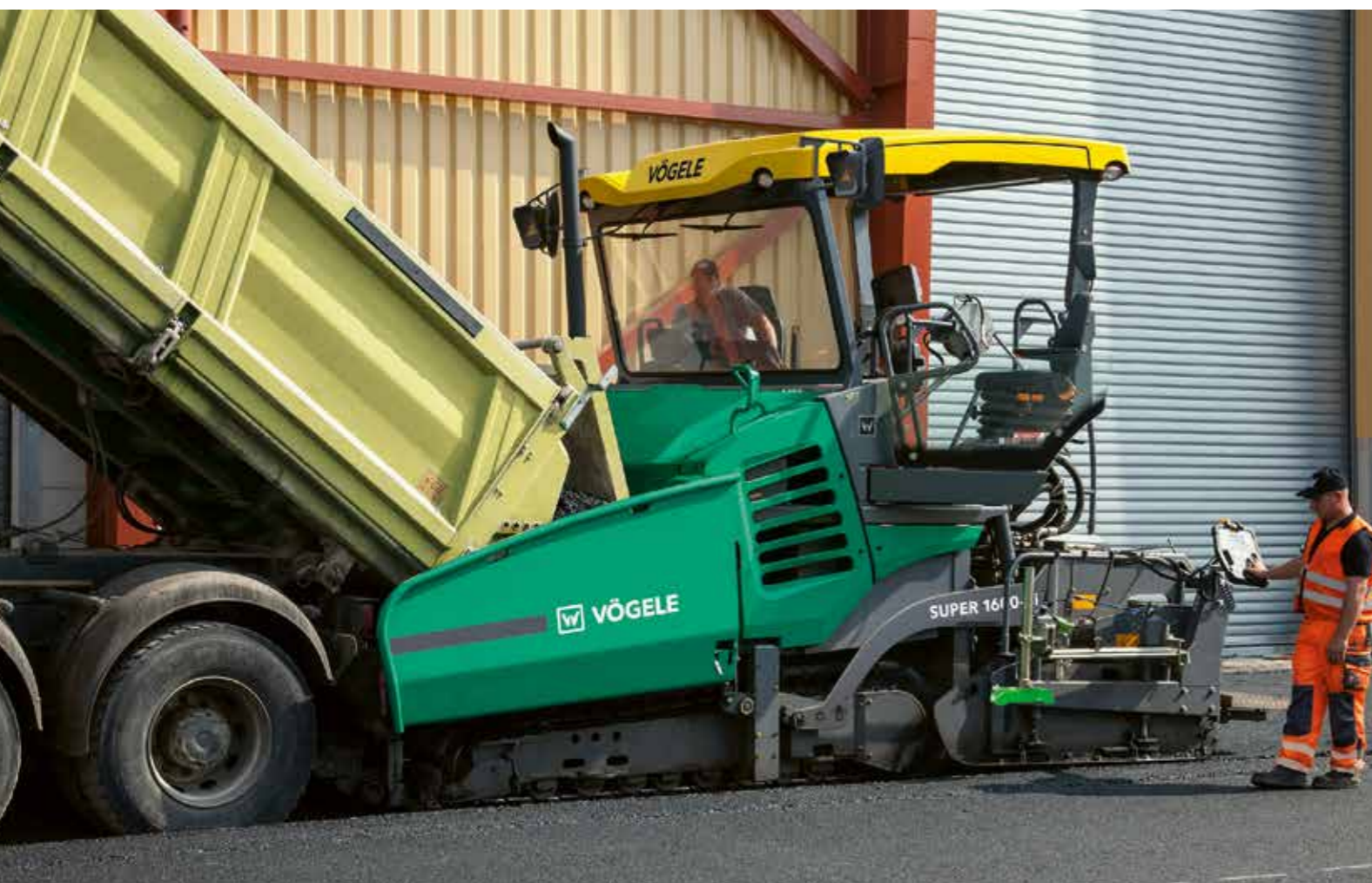
Il rullo respingente a molle "PaveDock" compensa in modo affidabile gli scossoni trasmessi dagli autocarri di rifornimento materiale.
