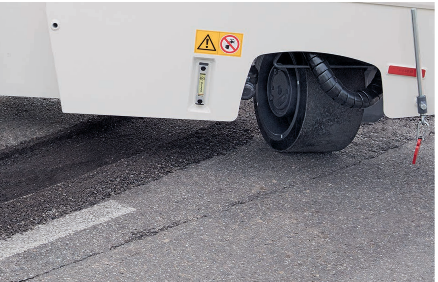
01 - 02 Der elektronisch geregelte Fahrtrieb ermöglicht exaktes Fräsen - wie z. B. an Straßeneinbauten.
