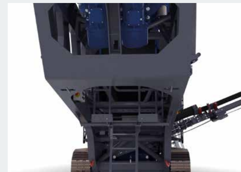
> MC 120(i) PRO - komfortabler Siebelagwechsel dank guter Zugänglichkeit
