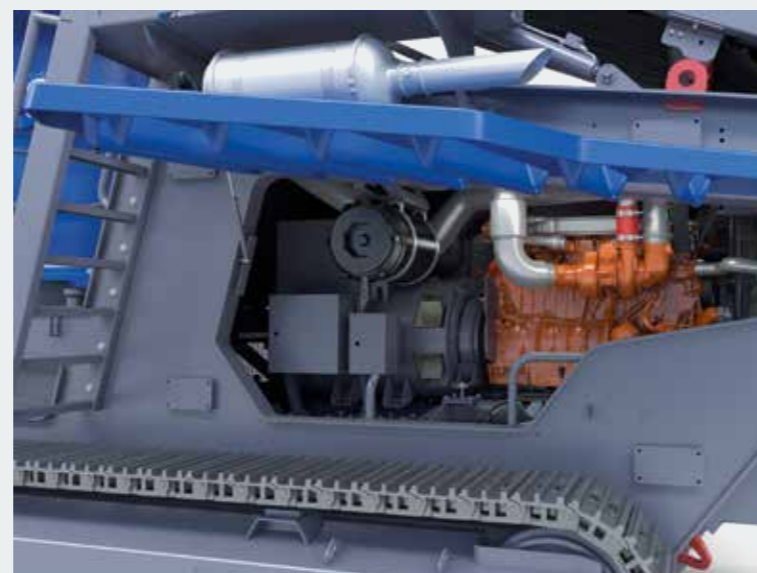
> MCO 110(i) PRO - komfortabler Zugang zum Motorraum, Betankung vom Boden aus möglich
