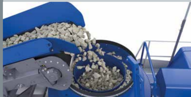
Chargement optimal du broyeur
