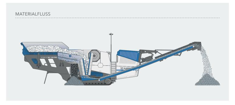
Die MOBICAT MC 120(i) PRO verfügt über eine großzügig dimensionierte Aufgabeeinheit, wodurch große Materialmengen problemlos mit einem Bagger oder Radlader aufgegeben werden können. Die hohe Performance der Anlage zeigt sich auch bei den Abmessungen des Brechereinlaufs und der extra langen Ausführung der beweglichen Brechbacke. Dies ermöglicht den Einzug von großem Gestein.
