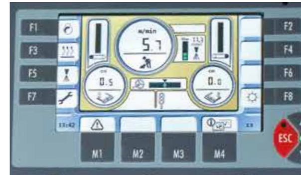
显示最大摊铺速度 显示屏会显示现有路面全宽度范围内都能覆盖乳化沥青时的最大可能摊铺速度。
