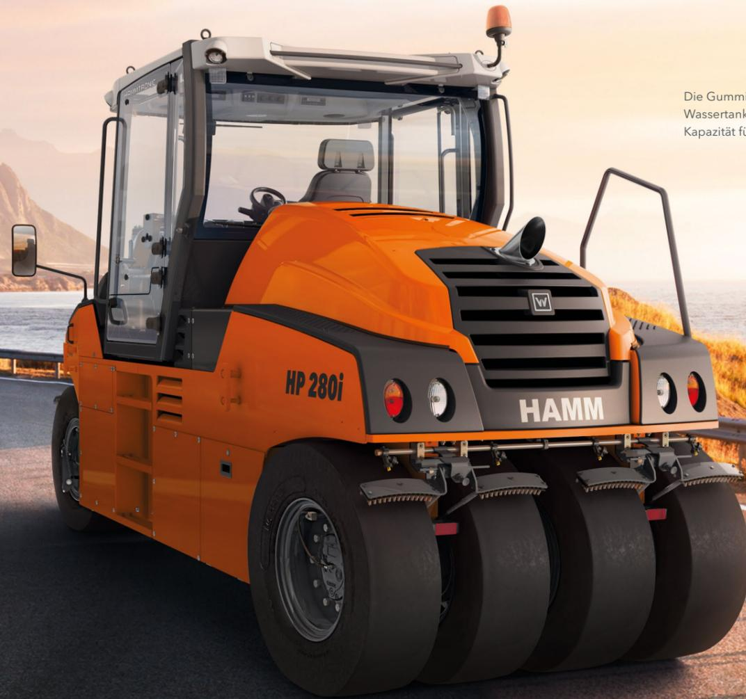
Die Gummiradwalzen sind mit großen Wassertanks ausgerüstet, sodass genügend Kapazität für einen Arbeitstag vorhanden ist.
