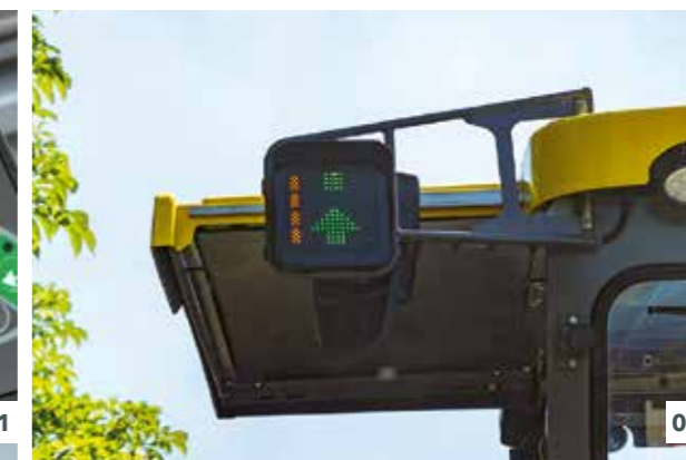
01 Écran indiquant les niveaux de vitesse de rotation 02 « PaveDock Assistant » (en option)
