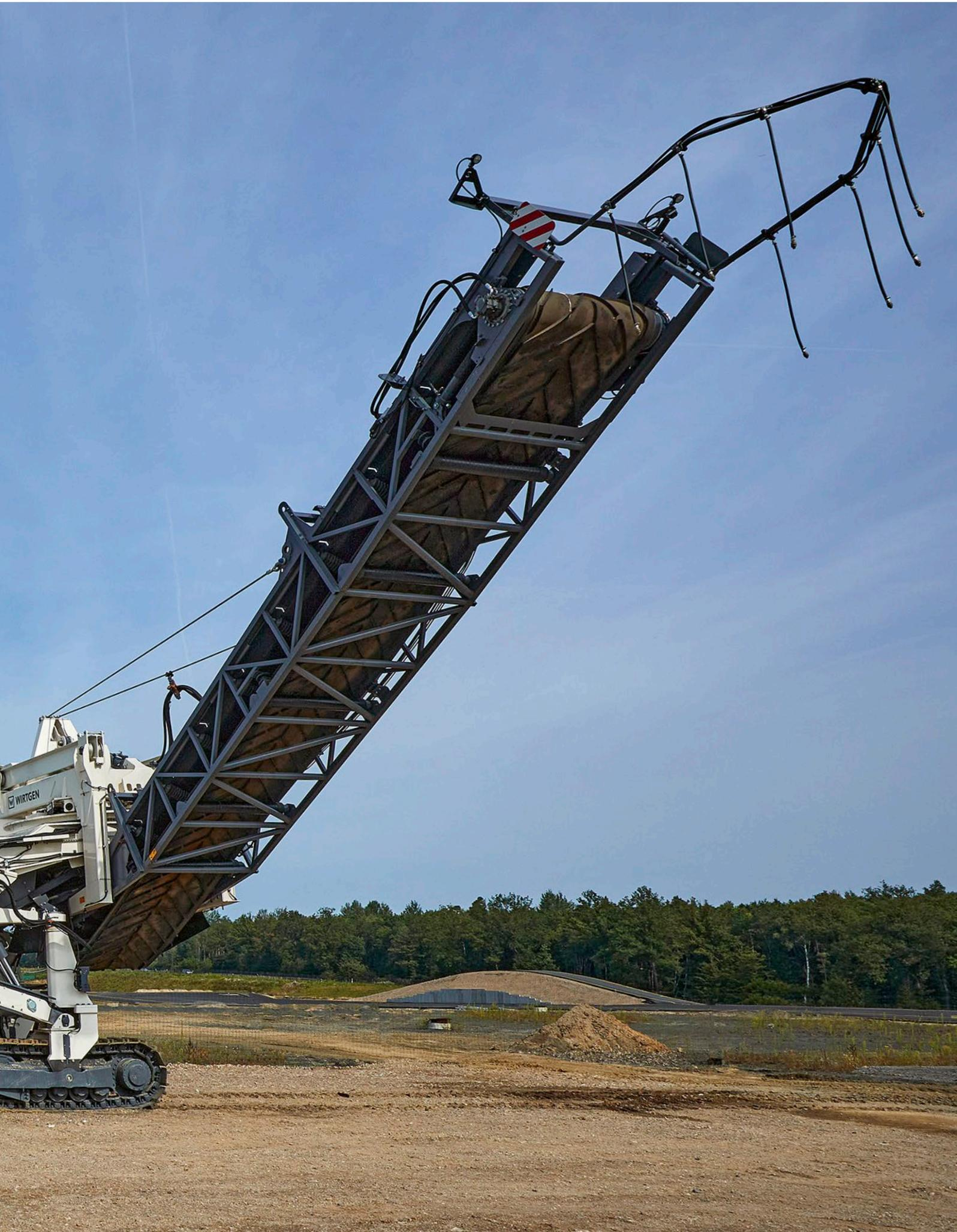
280 SM(i) 是一款高性能露天采矿机，剥离出的初级矿料可以通过卸料皮带直接装载到运输车辆上，也可以通过卸料皮带侧甩料堆料带，或不安装卸料皮带，通过后出料堆地的方式处理。无需钻孔和爆破，该机器就能以更环保的方式一次性对初级矿料进行剥离和破碎，并确保矿石品质。这款露天采矿机配备超强输料能力的后排料皮带，可通过液压调节高度和转动配重向左右两侧摆动，从而满足向 100 吨级以上矿卡持续送料。
