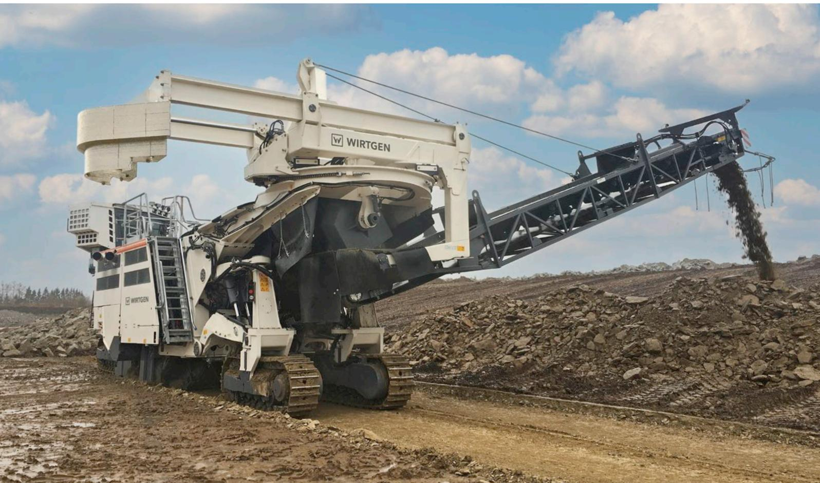
01 维特根切削转子采用高耐磨材料制成，确保了更高的切削产量。
