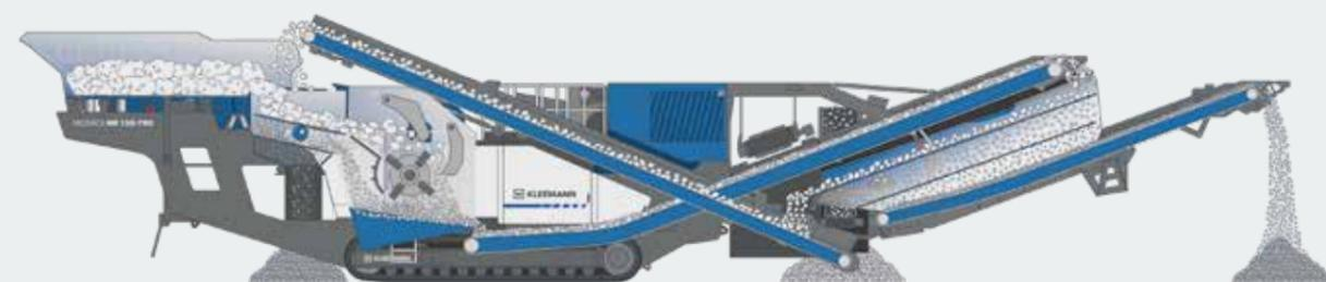
Le MOBIREX MR 130(i) PRO convainc par une excellente qualité de produit et des capacités de production très importantes. Le Continuous Feed System CFS assure une alimentation continue du broyeur. Grâce à réglage entièrement hydraulique de l'écartement, les paramètres de la machine peuvent être adaptés rapidement à l'application. Le système de surcharge offre une protection efficace du broyeur et une importante disponibilité de
